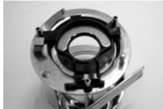
Foto 4: De frame van een uitgekilde ABU6500CTmag met magneetsysteem.
